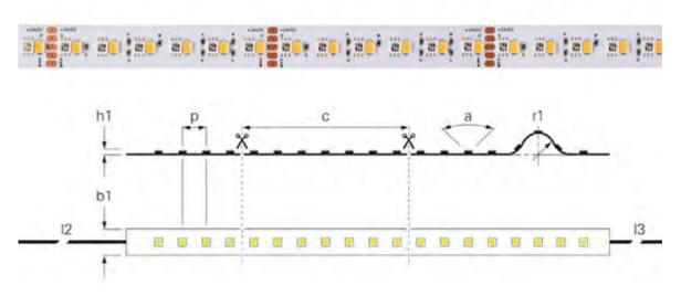
(p) Distance entre les LED 6,25 mm (c) Longueur du segment 50 mm (a) Angle d'émission 110 Degré (r1) Rayon de courbure min. 20 mm (h1) Hauteur 2 mm (b1) Largeur 10 mm (l2) Longueur du câble primaire 1 m (I3) Longueur du câble secondaire 1 m
