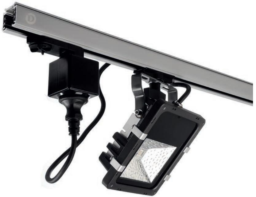
Mit unserem Steckdosenadapter lassen sich auf einfachste Art und Weise zusätzliche Geräte, Leuchten etc. mit Strom versorgen. In Kombination mit dem »Montageadapter für Zusatzkomponenten« [710054/55/56] lassen sich zusätzliche Scheinwerfer oder andere Geräte (bis 10kg) befestigen und mit Strom versorgen.
