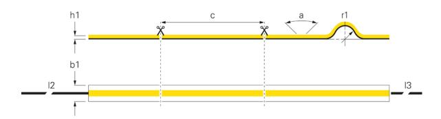
(p) LED Abstand 2,08 mm (c) Segment Länge 50 mm 120 Grad (a) Abstrahlwinkel (r1) Biegeradius min. 50 mm (h1) Höhe 2 mm (b1) Breite 10 mm (I2) Leitungslänge Primär 1 m (I3) Leitungslänge Sekundär 1 m
