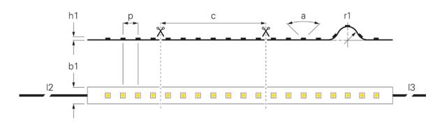
(p) LED Abstand 8,33 mm (c) Segment Länge 50 mm (a) Abstrahlwinkel 120 Grad (r1) Biegeradius min. 20 mm (h1) Höhe 3 mm (b1) Breite 5 mm (I2) Leitungslänge Primär 1 m (I3) Leitungslänge Sekundär 1 m
