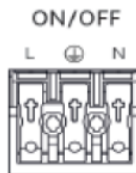
Abb.: 4 Anschlusschema: Dali oder schaltbar
