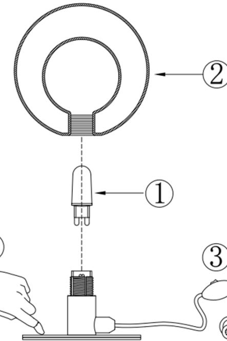
**ATTENZIONE:** la presenza di un piccolo foro nel vetro è necessario per poter far evaporare l'umidità all'interno del vetro nel corso della lavorazione. Non può quindi essere considerato un difetto.
