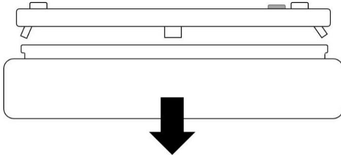
Abdeckung/Wanne von Unterteil durch gleichmäßiges ziehen lösen.
