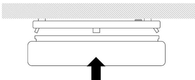
Nach erfolgreicher Montage drücken Sie die Abdeckung/Wanne vorsichtig auf das Unterteil an der Decke oder Wand. Hierzu müssen die Verschlüsse aufgestellt sein. Umgekippte Verschlüsse müssen aufgerichtet werden.
