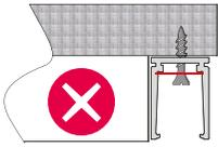
Der Schraubenkopf darf nicht über die Montagelinie drüber hinausragen.
