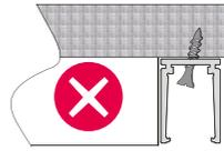
Die Schraube muss gerade eingeschraubt werden damit Sie nicht über die Montagelinie hinausragt.
