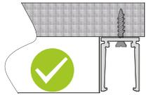
Verschrauben Sie das Profil mit dem Montageuntergrund und stellen Sie sicher, dass die Schraube bündig oder tiefer als die Montagelinie liegt.
