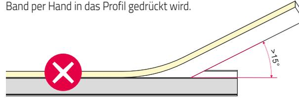
Der Installationswinkel darf nicht größer als  $15^\circ$  sein, während das Band per Hand in das Profil gedrückt wird.
