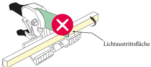
Der LED-Strip muss so liegen, dass auf die LED Platine in liegender Form drauf zugeschnitten wird.
