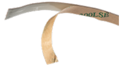
Die Klebe-Schutzfolie am zu montierenden Ende des LED-Strips ggf. ablösen.
