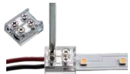
Einführen der abisolierten Anschlussleitung (0,32-1,32 mm 2 ) unter Beachtung der Polarität in die Kabel-Einspeiser Seite. Festdrehen der Schrauben mit Hilfe eines PH0-Schraubendrehers oder kleiner.
