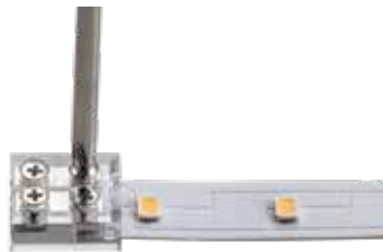
Festdrehen der Schrauben auf der Strip-Einspeisungsseite mit Hilfe eines PH0-Schraubendrehers oder kleiner. Bitte nicht extrem anziehen, da sonst die Gefahr des Durchbohrens der Platine gegeben ist.
